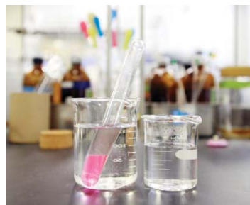
(上) 千葉教授が攪拌した液体が入った試験管を、ビーカーの水で冷やすと、ほんの数分間で、透明な層とピンク色の層に分離した。 (右) 院生の実験記録ノート。
